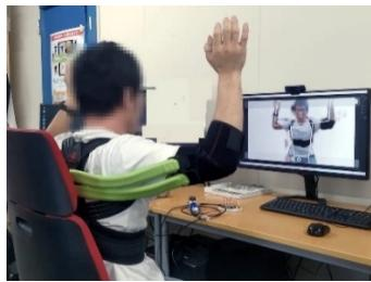
空気圧ゴム人工筋をもちいたウェアラブルなアシスト装置と、スマートフォンのビデオカメラをつかったモーションキャプチャによる体操支援システム(販売中製品)をデモ展示いたします。
