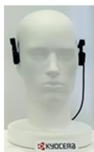
「聴覚拡張ヒアラブルデバイス」は、骨伝導イヤホンとバイノーラルマイクに、AI システムを組み合わせることにより周りの音への注意を代行し、聞き逃してしまう音に気付かせたり、その場で聞き返せたりできるデバイスです。
